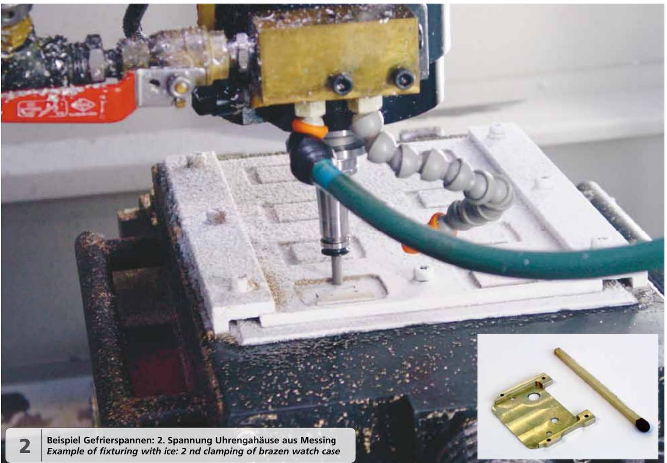
2 Beispiel Gefrierspannen: 2. Spannung Uhrehäuser aus Messing
