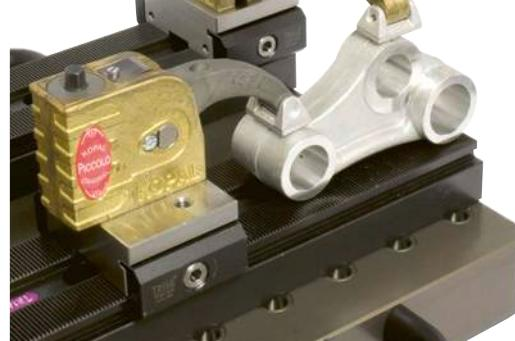
**NS** = Trägermodul freie Positionierung ohne Verzahnung
