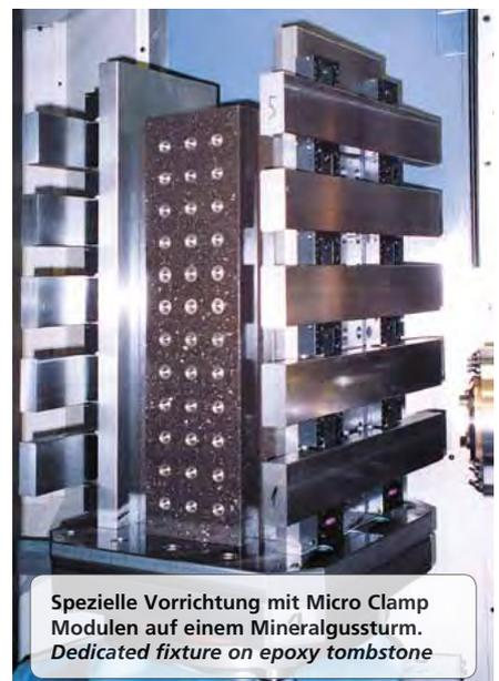
**Spezielle Vorrichtung mit Micro Clamp
