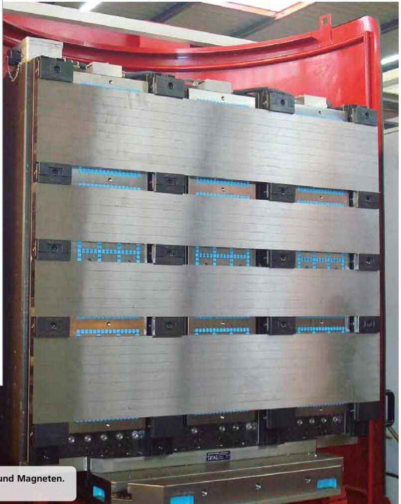
**Mineralgussturm kombiniert bestückt mit Power Clamp und Magneten.**
