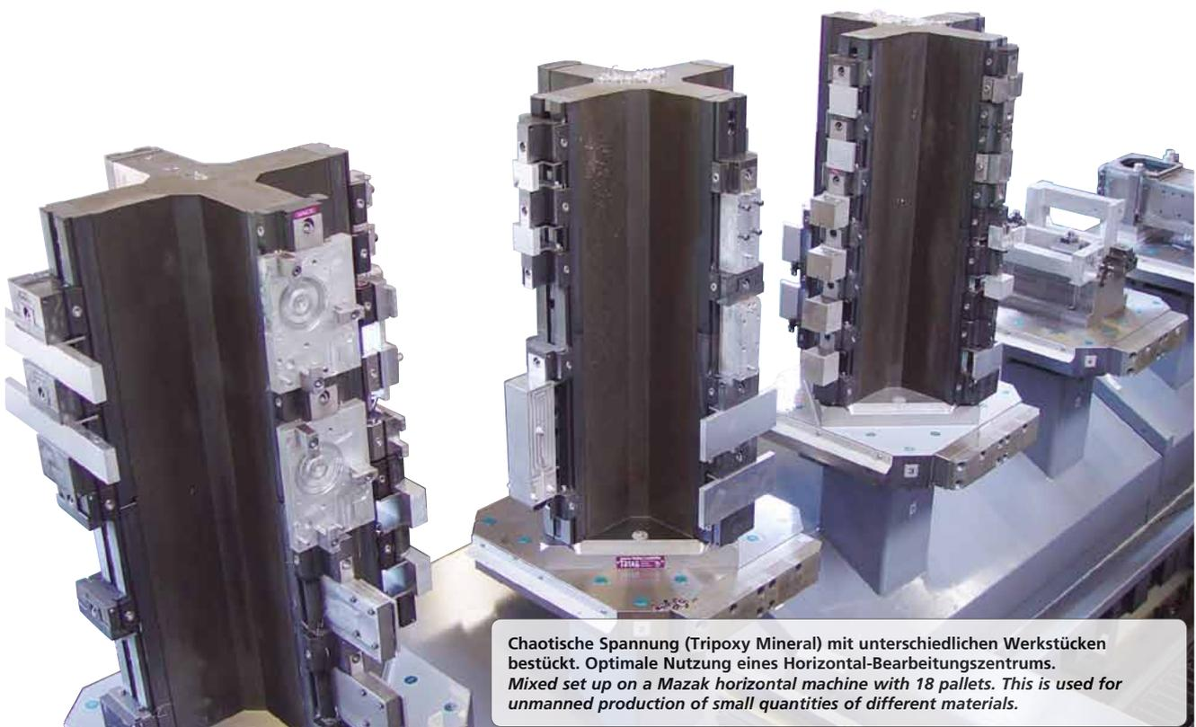
Chaotische Spannung (Tripoxy Mineral) mit unterschiedlichen Werkstücken bestückt. Optimale Nutzung eines Horizontal-Bearbeitungszentrums. Mixed set up on a Mazak horizontal machine with 18 pallets. This is used for unmanned production of small quantities of different materials.
