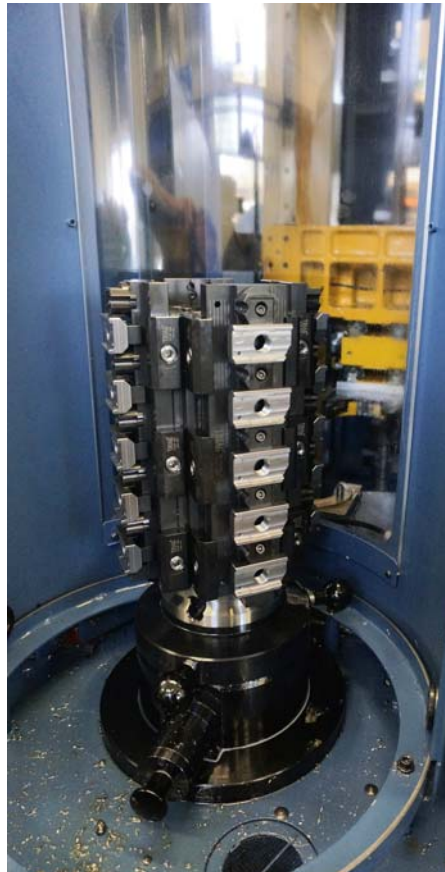
Bilder: Um die Grenzen der Maschine kennenzulernen, setzte Triag zuerst auf die Einzelspannung (links). Mit dem zukünftig vermehrten Einsatz der Mehrfachspannung (rechts) will man unter anderem den Ausstoss weiter erhöhen.
