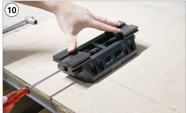
10 Schlitten mit Schraubenzieher zusammendrehen! Vorsicht: Die Schlitten müssen beide zur gleichen Zeit in das Gewinde der Spindel greifen!
