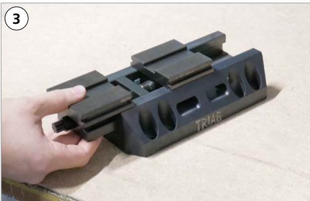
3 Spindel mit Mittellager und Schlitten herausziehen
