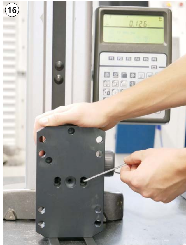
Bei - Differenz : Beide oberen Gewindestifte gleichmässig anziehen
