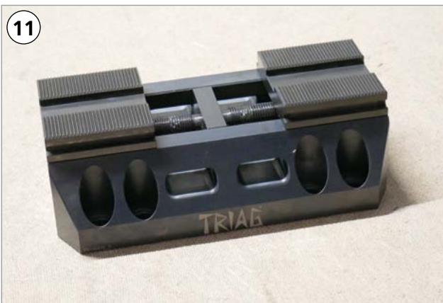
11 Kontrolle ob beide Schlitten den gleichen Abstand zum Gehäuse aufweisen. Ist dies nicht der Fall müssen die Schlitten neu eingefahren werden!
