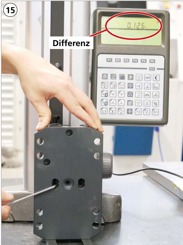
Bei + Differenz : Beide unteren Gewindestifte gleichmässig anziehen
