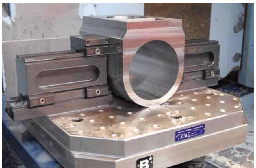
3 Für schwierige Spannsituationen: das modulare Werkstück-Spannsystem PowerClamp mit Basisschienen, Erhöhungmodulen und Linearspannmodulen (© Mücke)
