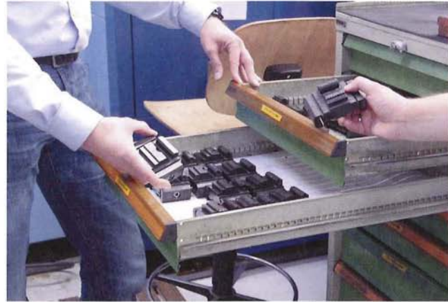
3 Flexibel und übersichtlich: Nur wenige Spannmodule genügen, um das große Spektrum an Bauteilen bei Wessel-Hydraulik zu spannen [© Triag]
