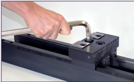
**1.** zwei Schrauben lösen
